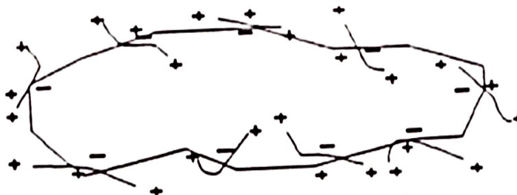
Hình 2. Sơ đồ hấp phụ của Polymer Cationic lên bề mặt các cấu tử sét (Gaidarov, Khubbatov, 2018; Gaidarov, 2018).
