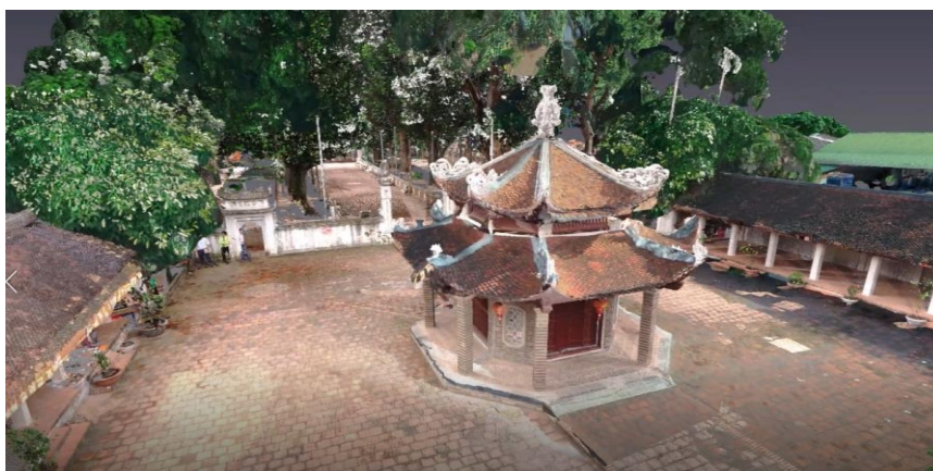
Hình 14. Mô hình 3D chi tiết nhà Bát Giác ở Chùa Láng được xây dựng tự động bằng phần mềm Skyline.
