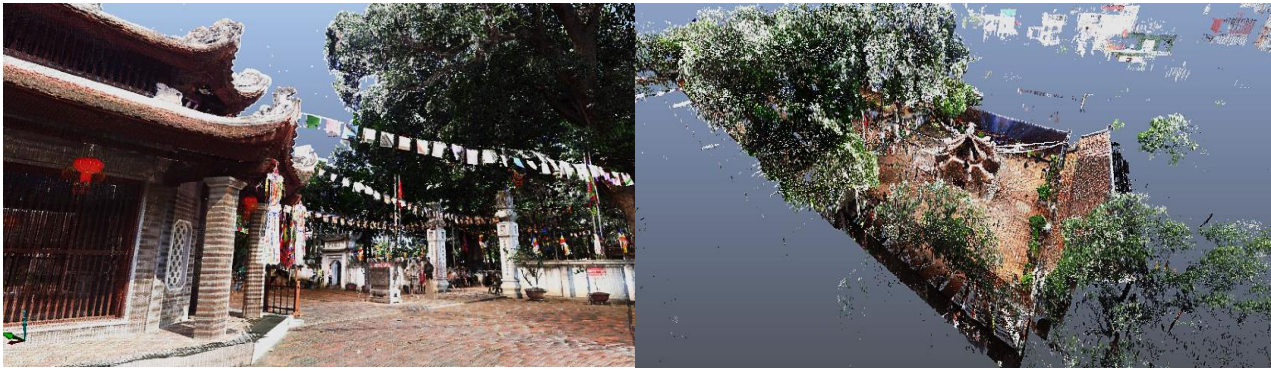
Hình 7 (a) Đám mây điểm từ hệ thống quét laser mặt đất; (b) Đám mây điểm từ hệ thống UAV.
