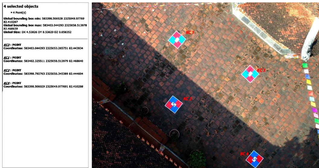
Hình 9. Trích xuất tọa độ các điểm khống chế ảnh của UAV.
