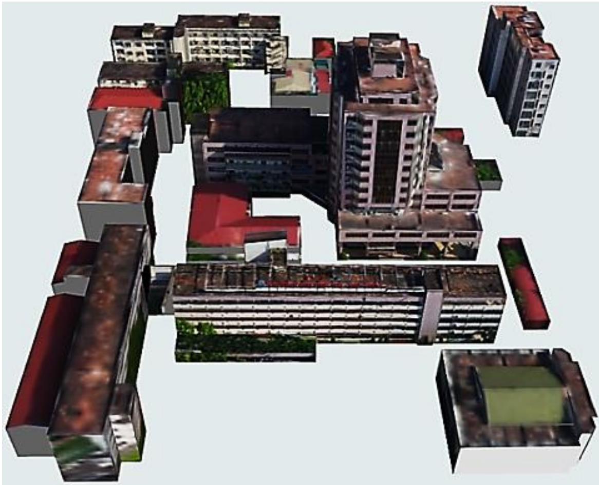
Hình 5. Mô hình 3D Khuôn viên Khu A HUMG - LoD2 ở định dạng CityGML.
