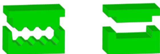
a) Hình vẽ 3D khuôn ép tạo hình và khuôn ép duỗi phẳng
