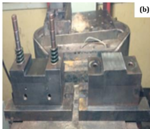
Hình 7. Khuôn: (a) Tạo hình, (b) Ép phẳng
