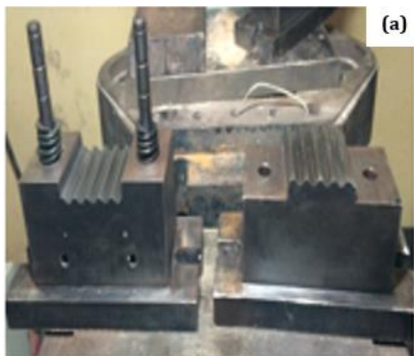
Hình 7. Khuôn: (a) Tạo hình, (b) Ép phẳng
