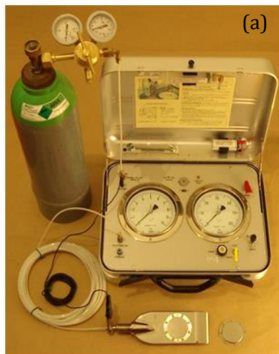
Hình 1. Sơ đồ thí nghiệm DMT. (a) Hình ảnh thiết bị DMT; Sơ đồ nguyên lý của thí nghiệm DMT.
