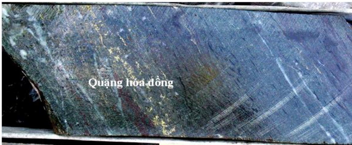
Ảnh 9. Lỗ khoan PK06, độ sâu 98.5 m, quặng hóa đồng trong đới trượt của đá andesit
