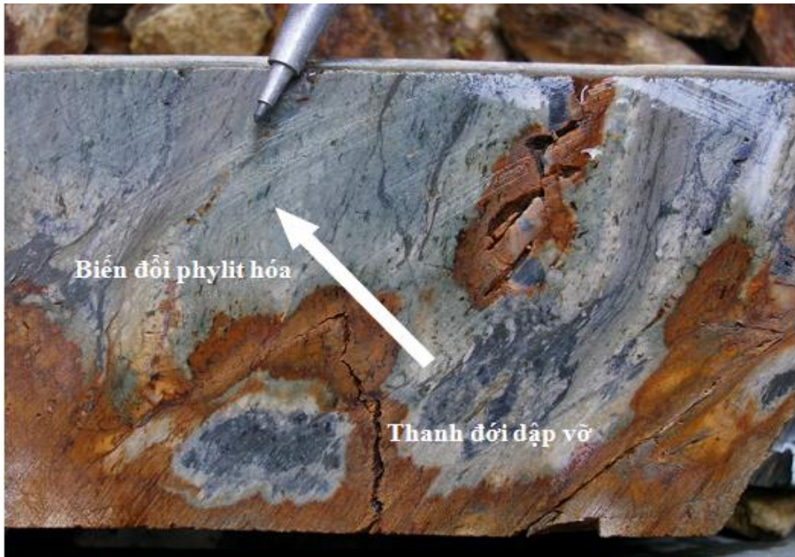
Ảnh 8. Lỗ khoan PK07, độ sâu 13.25 m, đới dăm kết hiện tượng hướng biến đổi đã bắt đầu từ dưới phải lên trên trái. Xung quanh đới dăm kết có biến đổi phylit.
