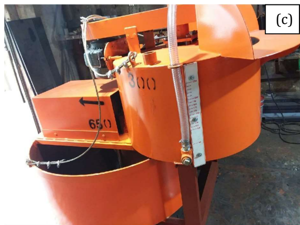
Hình 5. Thiết bị thi công chính trong công nghệ thi công cọc micropile: (a) máy khoan; (b) máy bơm vữa cọc; (c) máy trộn vữa.
