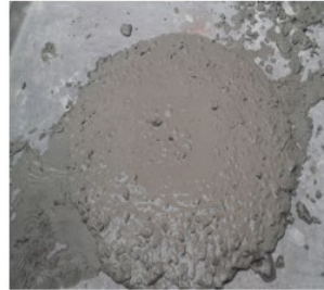
Hình 10. Kết quả kiểm tra độ chảy xòe.
