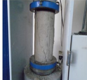
Hình 14. Nén mẫu trong phòng thí nghiệm.
