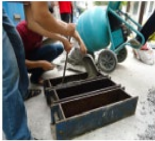
Hình 13. Đúc mẫu với khuôn mẫu tạo đầm.
