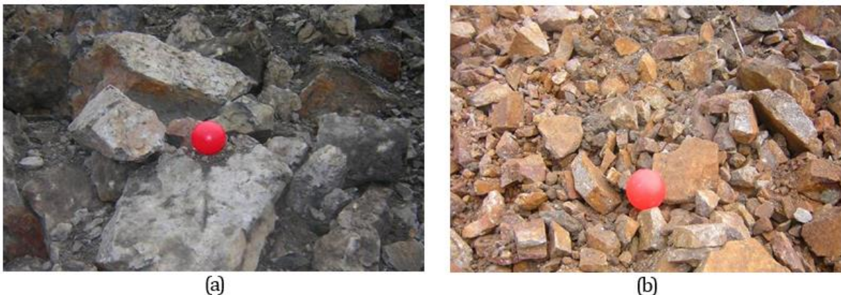
Hình 8. Chất lượng đập vỡ đất đá khi nổ mìn theo phương án truyền thống (a) và phương án nổ đề xuất (b).
