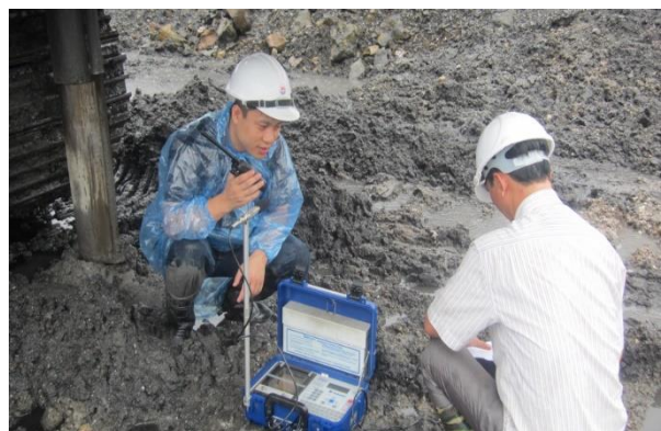
Hình 5. Vị trí đặt máy đo chấn động Blastmate III.
