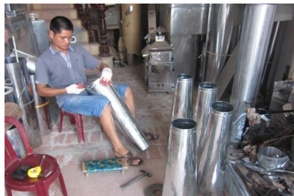
Hình 3. Sản xuất phễu nổ thực nghiệm.
