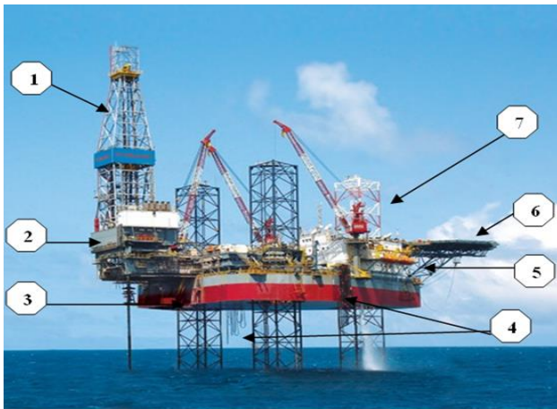
Hình 4. Giàn khoan tự nâng PV Drilling I 1. Tháp khoan, 2. Sàn khoan, 3. Thân giàn, 4. Hệ thống ống tiếp nhận dung dịch, hóa phẩm, dầu máy từ tàu dịch vụ, 5. Khu vực nhà ở, 6. Sân bay trực thăng, 7. Chân giàn khoan
