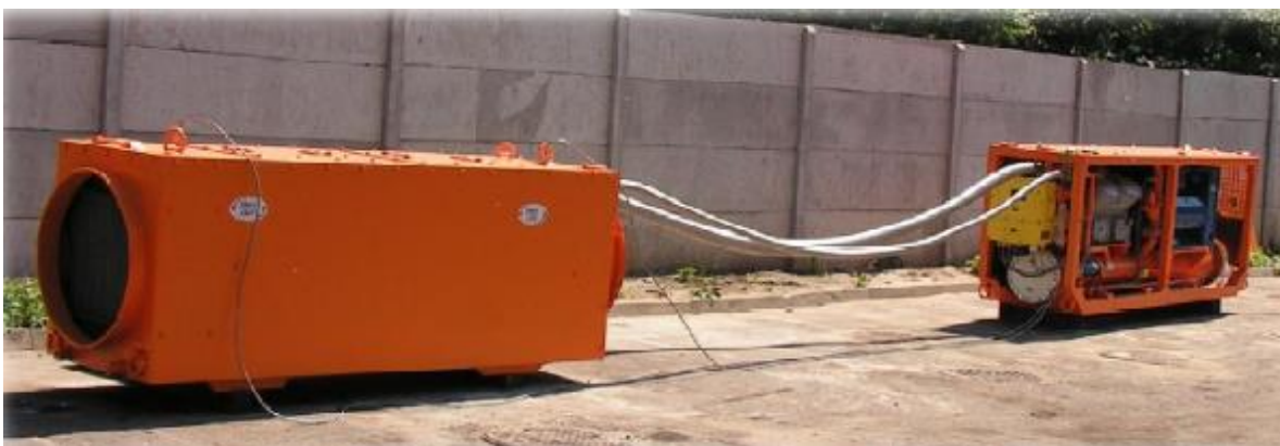
Hình 2. Hình ảnh thiết bị làm mát MK - 300.
